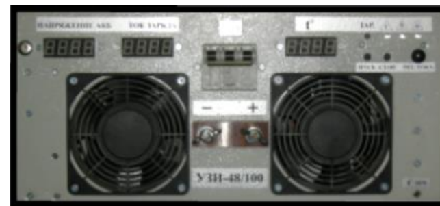
Передняя панель зарядного устройства УЗИ 80/100
