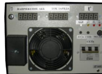
Передняя панель зарядного устройства УЗИ 32/60
